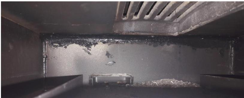
Test del papel: cerrar la puerta con un papel como se muestra en la foto. Sí el papel se desliza fácilmente, entonces hay un problema de estanqueidad y hay que cambiar la junta.
