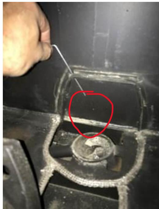
Revisar trampilla de inspección está correctamente colocada. Esta trampilla rectangular esta colocada debajo de las placas de vermiculita en la base de la cámara de combustión.
