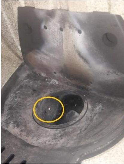
Se la estufa ha sido usada, hay que aspirar bien la zona bajo el brasero y asegurarse que el agujero de la bujía de encendido está limpio. Hoy después hay que sacar la bujía y verificar que no tiene cenizas dentro.
