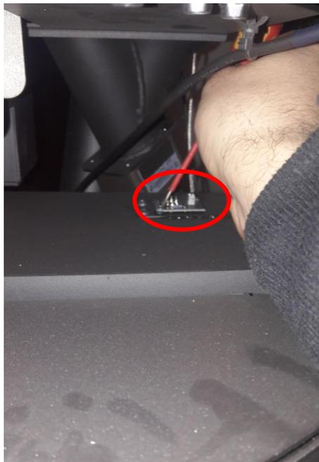
El nuevo sensor puede tardar entre 10-20 min hasta que se estabilice y transmita el valor correcto a la App. La medida del CO tiene que aparecer de color verde.
