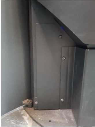
Foto 1: Abrir la puerta del silo para acceder a la placa base .
