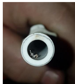
Confirmar que no hay suciedad dentro de la bujía
