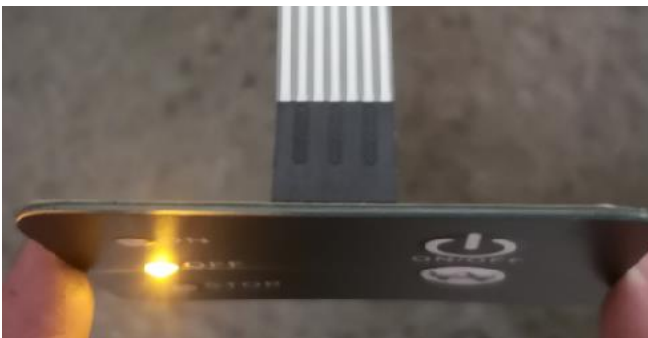
Luz del led cuando el cable está bien conectado al teclado.
