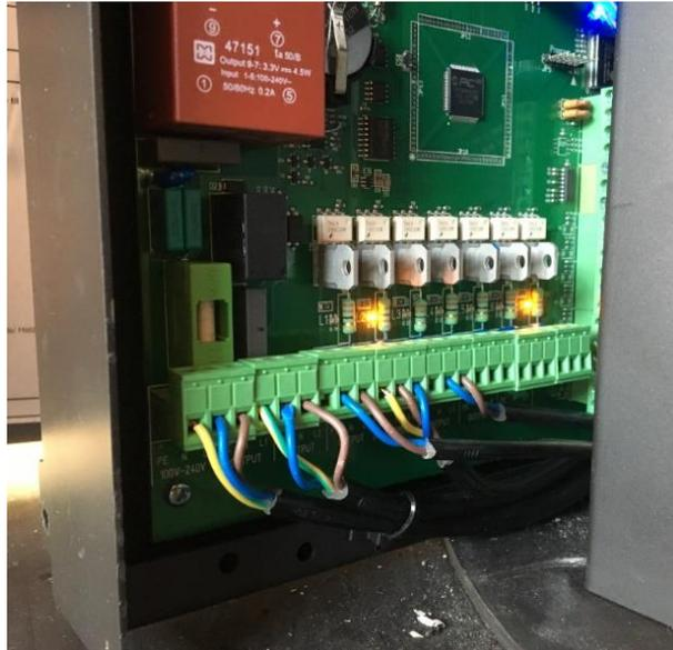
c) Hacer una foto para poder recordar como están conectados los cables. Desconectar el cable del teclado de la placa base (ver foto más abajo)
