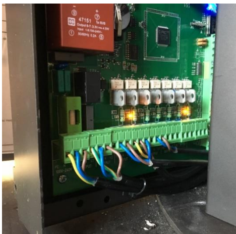
Foto 2: Scheda elettronica Aduro Hybrid
