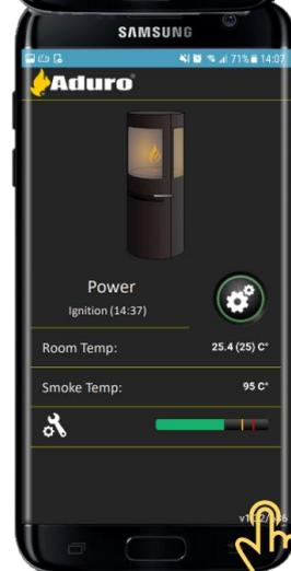
4. Premere di seguito 5-6 volte sul logo del lucchetto (vedere figura) per sbloccare il menu di servizio. Selezionare “Manuale” per eseguire un test di funzionamento delle singole parti.
