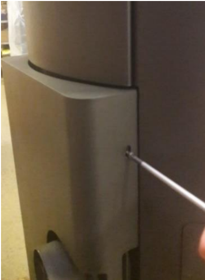
Figura 3: smontare il pannello posteriore della stufa
