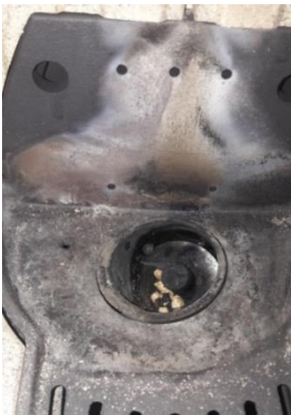
Figura 1: la coclea interna / corta dopo la rimozione della copertura
