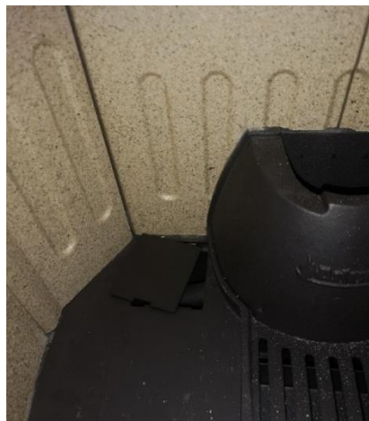
Figura 2: pannello chiuso non correttamente
