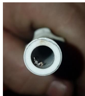
Figura 3: controllare la presenza di residui nella candelella
