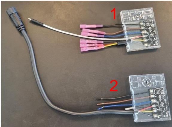
Sie unterscheiden sich im unteren Stecker. An Platine 1 sind die Kabel getrennt. Jedes Kabel muss mit dem entsprechenden Kabel am DraftOptimizer wieder verbunden werden. An Platine 2 wird der Stecker einfach mit dem im Draftoptimizer ersetzt. Die drei losen Kabel werden mit denen am Kontrollkasten verbunden.
