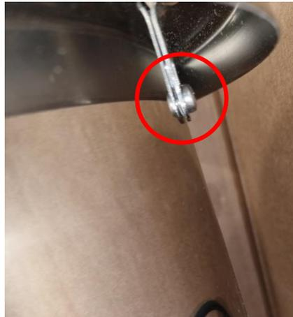
2. Lösen Sie die vier Muttern und nehmen Sie die Abdeckung ab.:
