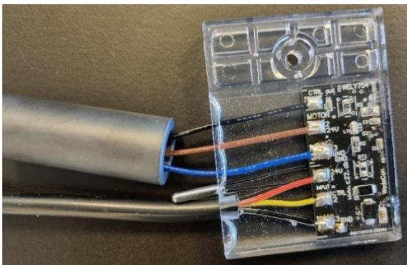
6. Installieren Sie die Steuerplatine und verbinden Sie die Kabel mit dem DraftOptimizer und Kontrollkasten:
