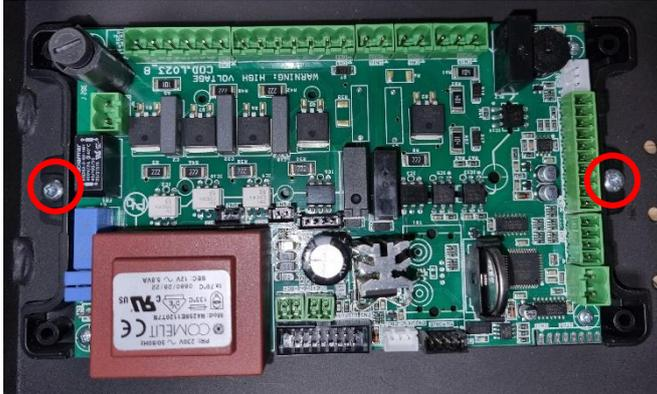
3. Platzieren Sie die neue Platine auf der Halterung und schrauben Sie sie fest. Verbinden Sie wieder alle Stecker wie in Punkt 6 gezeigt.
