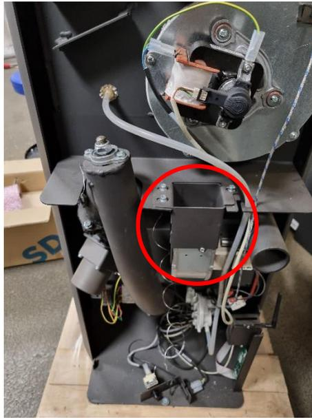
2. Trennen Sie die beiden Kabel zum Gebläse.
