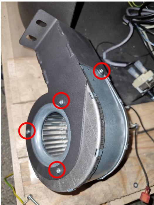
5. Überprüfen Sie, dass die Löcher im Luftkanal mit den Löchern der Abdeckplatte in einer Linie stehen bevor Sie die Halterung wieder am Gebläse montieren. Die Abdeckplatte ist der obere, drehbare Ring.
