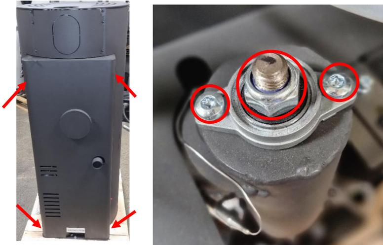
4. Lösen Sie nun die 4 Schrauben, mit denen der Motor am Korpus befestigt ist:
