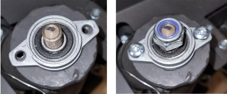
10. Um den Motor wieder mit dem Korpus zu verbinden, achten Sie darauf, dass dieser in der richtigen Position steht: Die Achse des Motors befindet sich nicht mittig, daher muss die kurze Seite nach unten gerichtet sein, wie auf diesem Bild:
