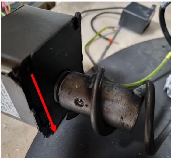
11. Drehen Sie den Motor (den runden Teil) so, dass die Kabel einfach wieder mit der Klemme verbunden werden können. Befestigen Sie den Motor mit den 4 Schrauben am Korpus. Nun können Sie die Mutter an dem Schneckengewinde an der Rückseite festziehen.
