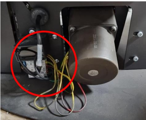
3. Entfernen Sie die 4 Schrauben mit dem TORX 20 Schraubendreher an der hinteren Abdeckung und entfernen Sie diese. Lösen Sie die Mutter am Gewinde der externen Schnecke und die zwei Schrauben am Lager. Legen Sie die Teile zur Seite:
