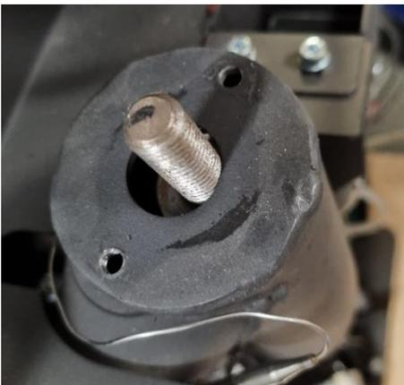
9. Zentrieren Sie das Gewinde: Setzen Sie das Lager auf das Gewinde und befestigen sie es mit den zwei Schrauben. Schrauben Sie die Mutter auf das Gewinde, aber ziehen Sie sie noch nicht ganz fest:
