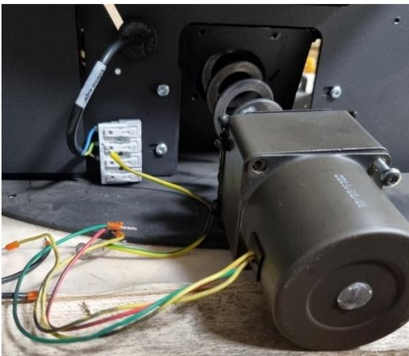
12. Verbinden Sie die Motorkabel an der Klemme wie hier dargestellt:
