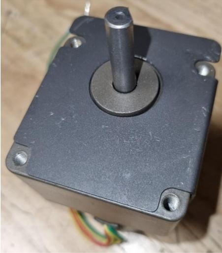
7. Tauschen Sie nun Motor, Schnecke oder beides aus. Verbinden Sie die Bauteile so, dass die Sicherungsschraube auf einer Linie mit der abgeflachten Seite der Motorachse steht und dass sich die Unterlegscheibe aus Kunststoff darauf befindet. Befestigen Sie die Schraube mit dem Inbusschlüssel:
