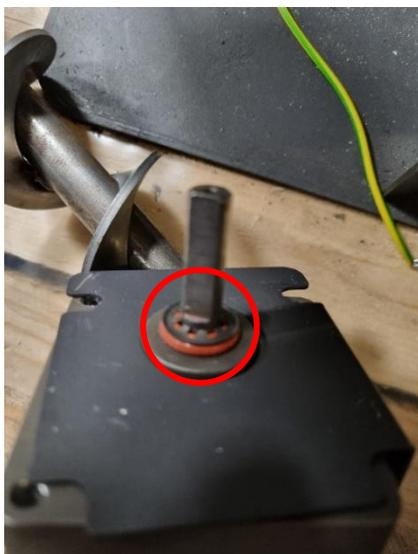
8. Verbinden Sie die Bauteile so, dass die Sicherungsschraube auf einer Linie mit der abgeflachten Seite der Motorachse steht:
