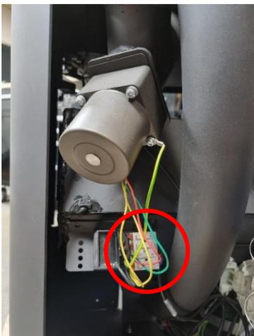
3. Drehen Sie die 4 Schrauben am Motor heraus. Wichtig: Merken oder notieren Sie sich an welcher Stelle jede Schraube war und wie viele Unterlegscheiben an jeder befestigt sind. Die Schrauben und Scheiben müssen bei der Montage des Austauschmotors an den exakt gleichen Positionen befestigt werden.
