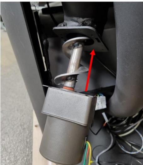
10. Verbinden Sie die Motorkabel an der Klemme wie hier dargestellt:
