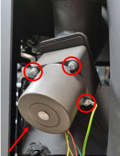
4. Halten Sie einen Beutel oder einen Behälter unter den Schneckenkanal bevor Sie den Motor samt Schnecke entfernen. Dadurch werden herausfallende Pellets aufgefangen. Ziehen Sie nun die Schnecke samt Motor vorsichtig aus dem Kanal. Es kann helfen die Schnecke dabei etwas hin und her zu bewegen.
