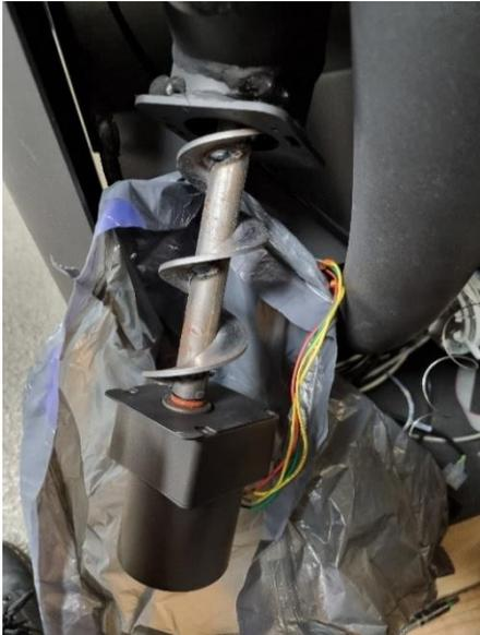
5. Trennen Sie nun die Schnecke vom Motor, indem Sie die Befestigungsschraube mit dem 3mm Inbusschlüssel lösen.
