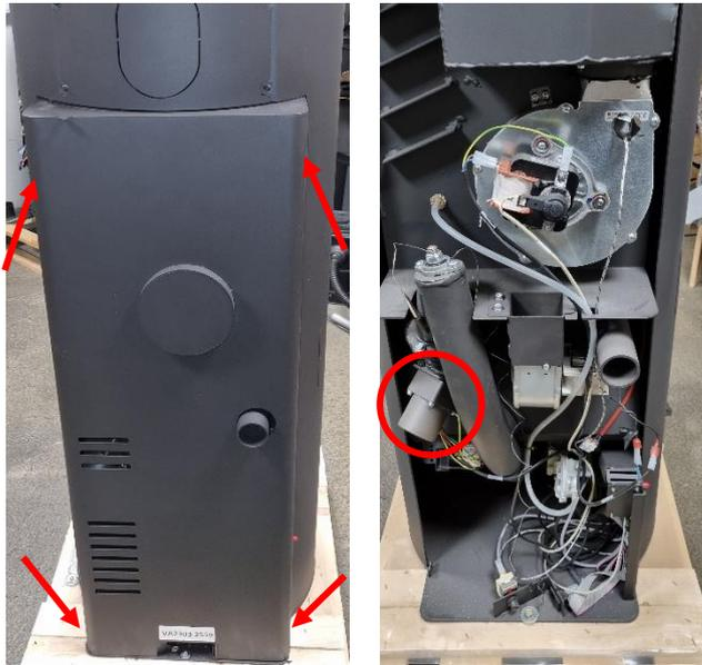
2. Trennen Sie die Kabel des Motors von der weißen Klemme: Drücken Sie dazu die Verschlussknöpfe an der Klemme und ziehen Sie die Kabel vorsichtig heraus.
