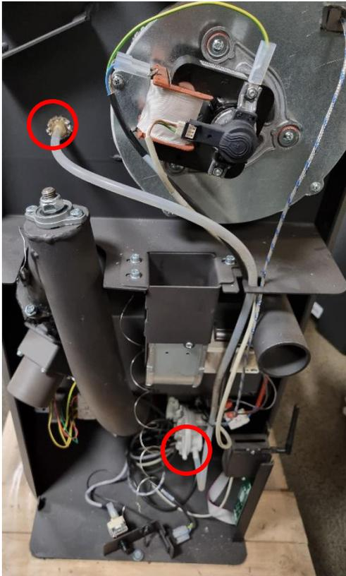
2. Stellen Sie sicher, dass die Kabelstecker an den korrekten Anschlüssen am Druckschalter sitzen. Überprüfen Sie außerdem, dass die Kabel mit der Steuerplatine verbunden sind.
