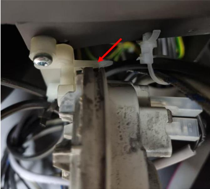
4. Lösen Sie die Kabelstecker vom Druckschalter:
