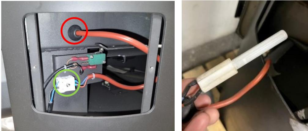
3. Installieren Sie nun den neuen Zünder. Der Zünder wird in ein kleines Rohr geführt, welches in dem Loch sitzt. Stecken Sie die Gummimuffe in das Loch und schieben Sie das Kabel so weit hinein, bis ein Widerstand spürbar ist. Ziehen Sie das Kabel dann wieder 5mm heraus.
