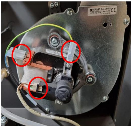
3. Lösen Sie die insgesamt 6 Schrauben an den 3 Halterungen welche das Gebläse mit dem Ofen verbinden:
