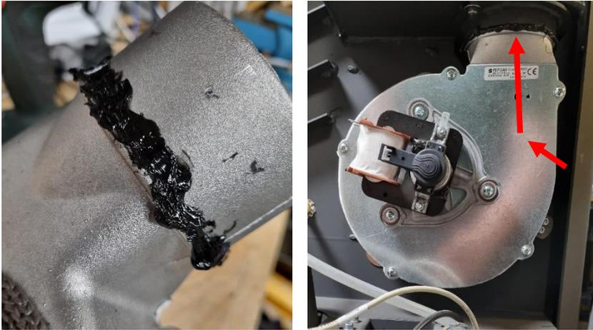
6. Bringen Sie auch etwas hitzebeständiges Silikon an der Rückseite der Metallabdeckplatte des Rauchtemperatursensors an. Bringen Sie die Platte wieder an und befestigen Sie die Schraube. Schieben Sie den Sensor durch das Loch und decken ihn wieder mit dem Filz ab:
