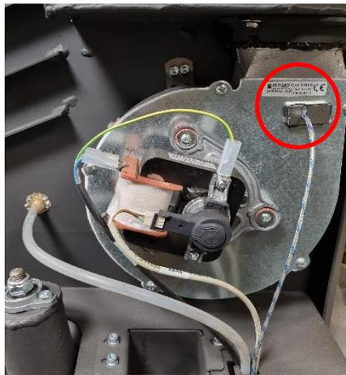
1. Entfernen Sie den Sensor, indem Sie die Abdeckplatte aus Metall entfernen und vorsichtig am Kabel ziehen:
