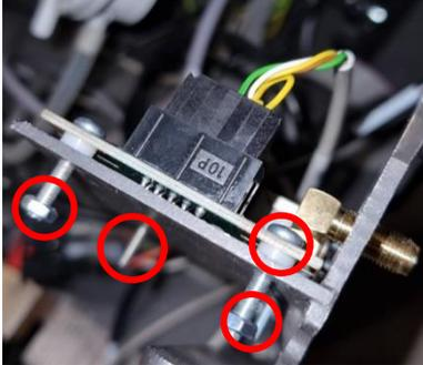
5. Installieren Sie nun das neue Wi-Fi Modul. Wichtig: Verwenden Sie die Unterlegscheiben aus Kunststoff damit das Modul nicht mit der metallischen Oberfläche in Kontakt kommt.
