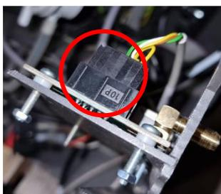
4. Lösen Sie die 4 Schrauben und bewegen Sie das Wi-Fi Modul nach links, um das Gewindestück aus der Öffnung zu ziehen:
