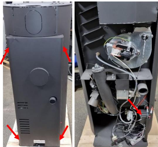
2. Entfernen Sie die Abdeckplatte des Wi-Fi Moduls, indem Sie die zwei Muttern lösen. Nehmen Sie nun die Platte ab:
