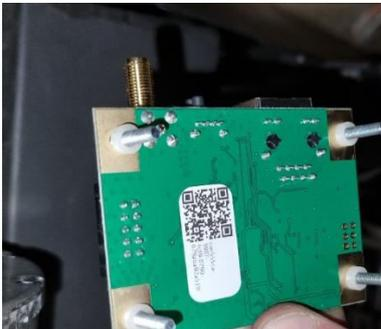
6. Verbinden Sie das Datenkabel mit dem Wi-Fi Modul.
