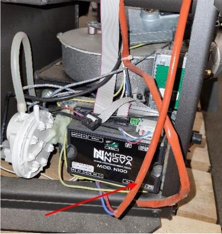
Das Motorkabel ist mit dem COC-Ausgang der Micro Nova N100-Platine verbunden. Die Verbindung läuft durch eine Sammelanschlussbuchse:
