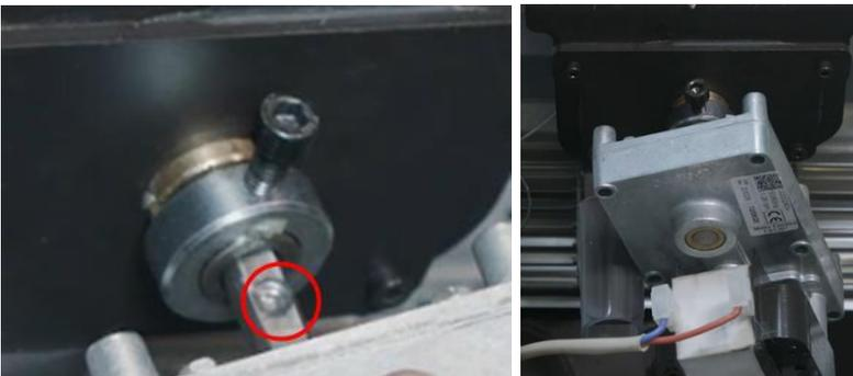
6. Führen Sie „Initial load“ oder eine normale Zündung durch, und schauen Sie, ob Pellets in den Brennkegel geführt werden. Wenn dies der Fall ist, funktioniert der Getriebemotor korrekt.
