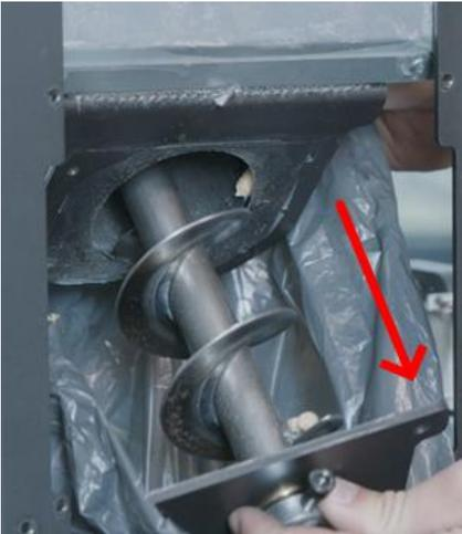
6. Demontieren Sie alle Teile von der Schnecke (Platte, Messingbuchsen, Metallscheibe):
