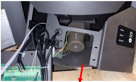
5. Bevor Sie das Flachbandkabel verlegen, achten Sie auf seine Ausrichtung (siehe rote Markierung auf dem Kabel), um es auf der Steuerplatine und dem neuen Display auf die gleiche Weise zu verlegen. Ersetzen Sie das Kabel, das von der Steuerplatine zum Display führt, durch das neue Kabel. Das Kabel muss hinter dem Motor geführt werden.
