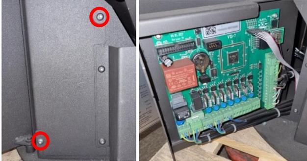
3. Lösen Sie die vier Schrauben, die die Abdeckplatte halten (siehe Bild). Eventuell müssen auch einige der zum Motor führenden Kabel entfernt werden.
