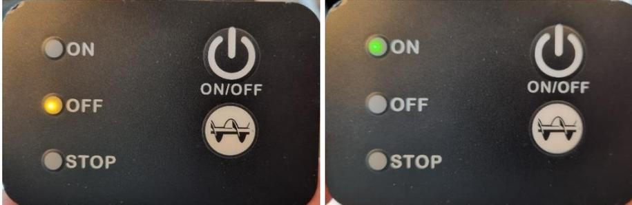
4. Wenn das Display korrekt funktioniert, trennen Sie die Stromversorgung des Ofens und das Kabel zum Display. Ziehen Sie den Aufkleber ab, der den Kleber auf der Rückseite des Displays abdeckt. Schließen Sie das Kabel wieder an und setzen Sie das Display an die Stelle, an der das alte saß.
