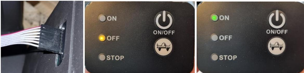
8. Wenn das Display korrekt funktioniert, trennen Sie die Stromversorgung des Ofens und das Kabel zum Display. Ziehen Sie den Aufkleber ab, der den Kleber auf der Rückseite des Displays abdeckt. Schließen Sie das Kabel wieder an und setzen Sie das neue Display an der Stelle ein, an der das alte saß.
