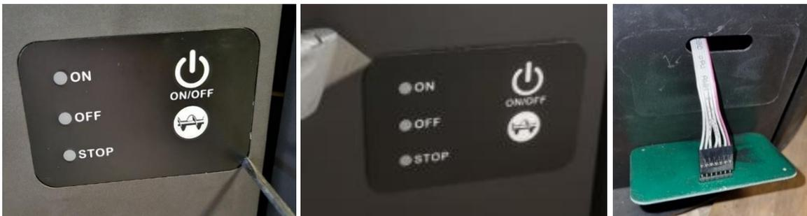
3. Verbinden Sie das Kabel des alten Displays mit dem neuen Display, schließen Sie den Ofen an die Stromversorgung an und testen Sie die Funktion der beiden Tasten und der LEDs, bevor Sie das neue Display montieren.
