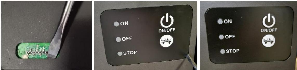
7. Schließen Sie das Kabel an das neue Display an. Schließen Sie den Ofen an die Stromversorgung an und testen Sie die Funktion der beiden Tasten und der LEDs.
