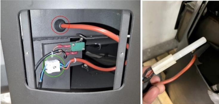
Montieren Sie nun den neuen Keramikzünder. Führen Sie den Zünder in die Öffnung und befestigen Sie die Gummimuffe. Schieben Sie das Kabel hinein bis der Keramikzünder am Ende ankommt. Im Anschluss ziehen Sie das Kabel wieder 5mm zurück.
