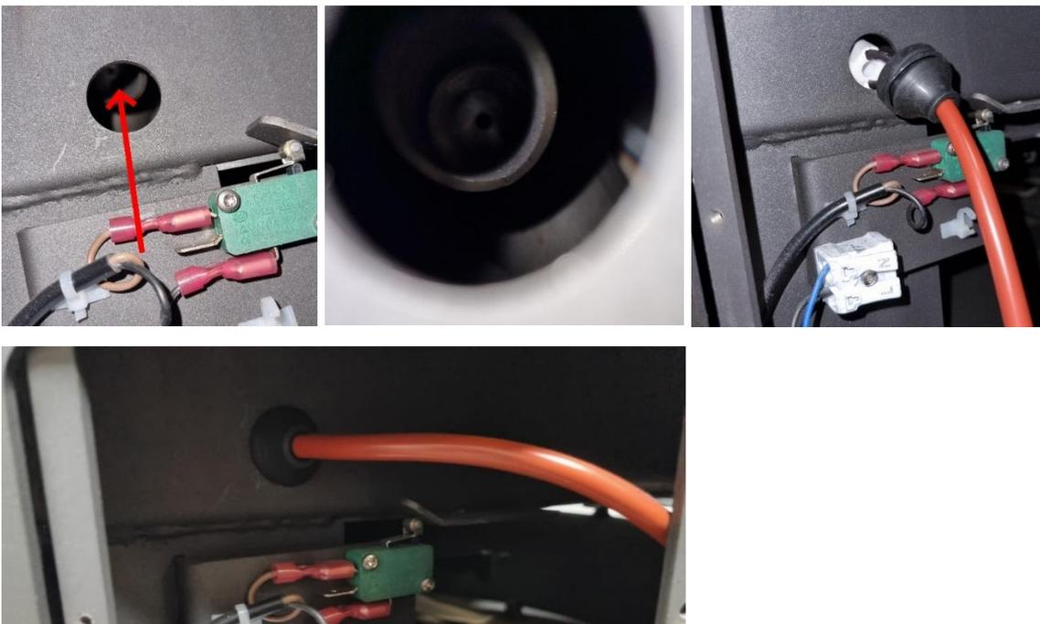
Der Keramikzünder lässt sich justieren, indem ein kleiner runder Gegenstand in das Loch eingeführt wird und so den Elektrozünder korrekt platziert:
