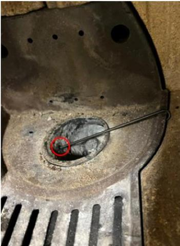
Sobald der Keramikzünder korrekt platziert ist, können Sie die Kabel wieder mit dem Kontakt verbinden (das blaue Kabel in „N“ und das rote/braune in „L“):
