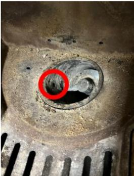
Um zu kontrollieren, ob der Keramikzünder funktioniert, können Sie den Ofen ohne Pellets in der Schnecke starten. Wenn die Zündung missglückt, kontrollieren Sie, ob es im Brennkegel und um die Öffnung zum Keramikzünder herum warm ist.
