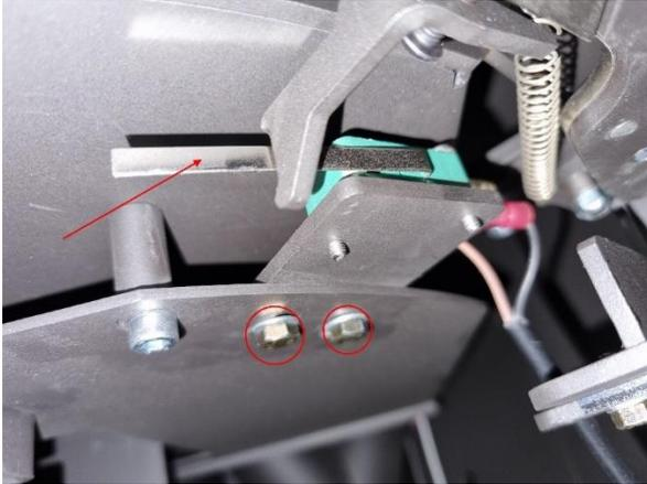
8. Schalten Sie den Ofen ein und stellen Sie sicher, dass der Türkontakt registriert, wenn die Ofentür geöffnet und geschlossen wird. Dies wird sowohl in der Aduro Hybrid App als auch über das Display des Ofens angezeigt.
