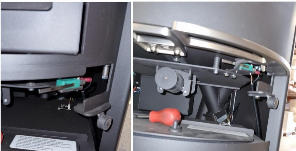
7. Ziehen Sie vorsichtig den Türkontakt in Richtung Ofentür, bis der Hebel des Türkontaktes mit der Ofentür in Kontakt kommt und klickt. Halten Sie ihn in dieser Position und ziehen Sie die Schrauben nun endgültig fest:
