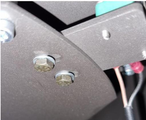
6. Die Position des Türkontaktes muss justiert werden, um sicherzugehen, dass er richtig platziert ist. Ansonsten registriert er nicht, wenn die Ofentür geöffnet oder geschlossen wird. Ziehen Sie den Türkontakt so weit wie möglich heraus und schließen Sie die Ofentür:
