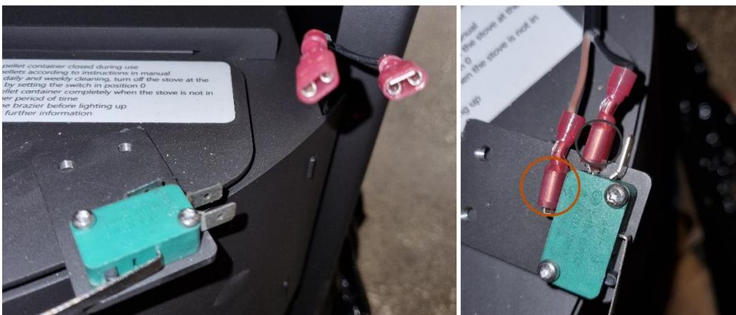
5. Montieren Sie jetzt den Beschlag mit Türkontakt und Kabel am Ofen. Drehen Sie die Schrauben anfangs handfest, damit die Position des Beschlages noch justiert werden kann. Der Beschlag wird oberhalb der Montageplatte im Ofen angebracht und mit den Schrauben von unten durch die Öffnungen befestigt:
