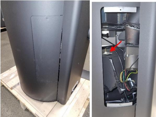
2. Demontieren Sie das Kabel vom alten Sensor, indem Sie am Stecker ziehen, nicht am Kabel:
