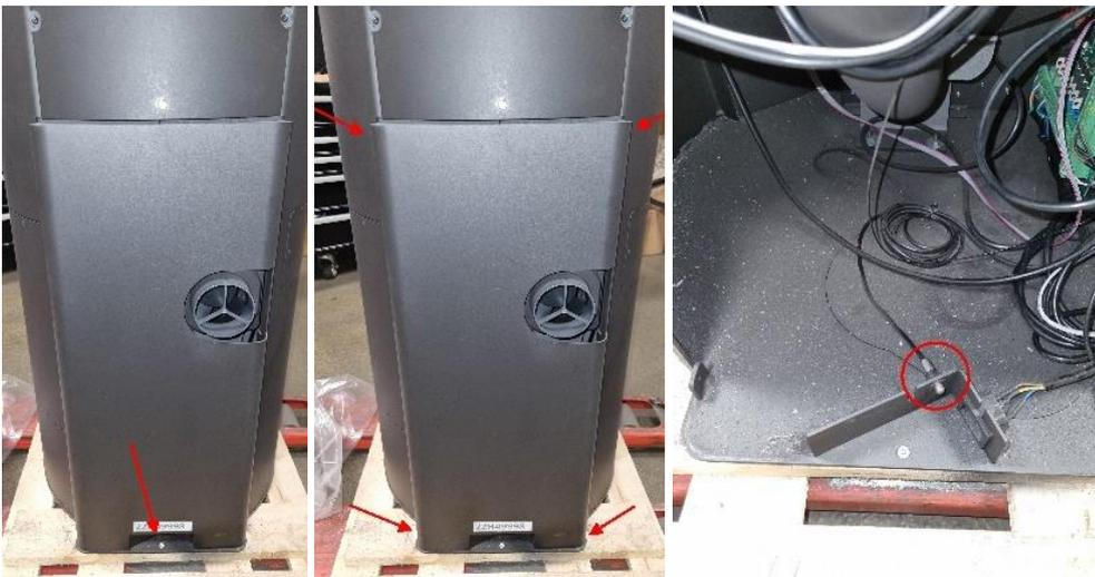
Um den Sensor vom Kunststoffhalter zu trennen, müssen Sie an der Metallverkleidung drücken/ziehen.
