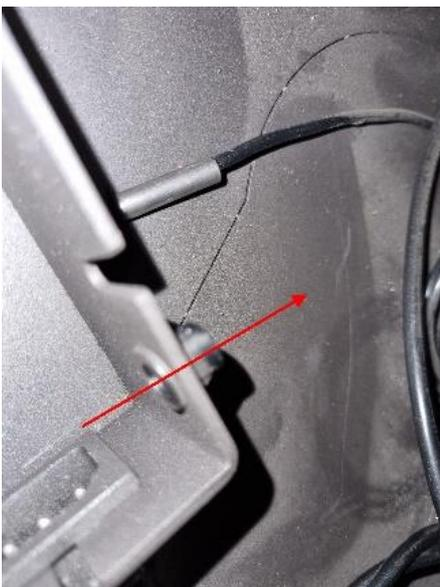
Der alte Sensor muss auf der Steuerplatine des Ofens mit dem neuen Sensor ausgetauscht werden. Die Steuerplatine ist unten rechts am Ofen angebracht. Ziehen Sie den Stecker – nicht das Kabel. Wechseln Sie die alten Kabel mit den Kabeln des neuen Sensors und schließen Sie den Stecker wieder an die Steuerplatine:
