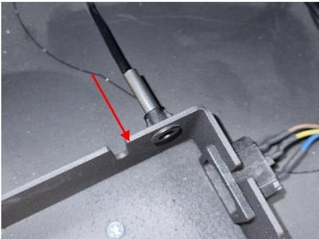
Nun ist der Raumtemperatursensor ausgetauscht. Platzieren Sie die Rückverkleidung mit den vier Schrauben und Sie sind fertig.
