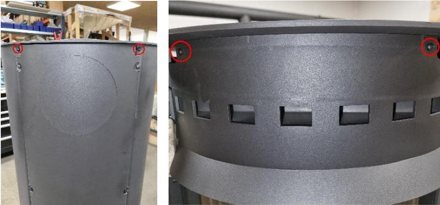
Der Rauchsensor ist mit einer Gewindestange und einer Mutter an der Oberfläche befestigt. Lösen Sie die Mutter und tauschen Sie den alten Rauchsensor mit dem neuen aus, ziehen Sie die Mutter anschließend wieder fest. Das Kabel für den Sensor wird durch das Loch hinter dem Sensor gezogen:
