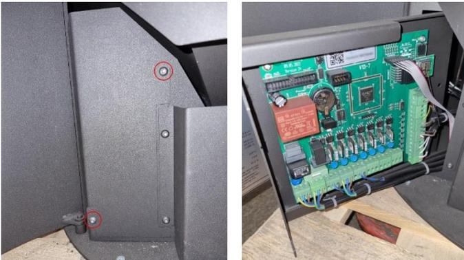
Entfernen Sie die grüne Anschlussbuchse von der Steuerplatine, indem Sie an der Buchse und nicht am Kabel ziehen. Lösen Sie die Schrauben in der Buchse und tauschen Sie die Kabel aus, um den alten Sensor auszuwechseln:
