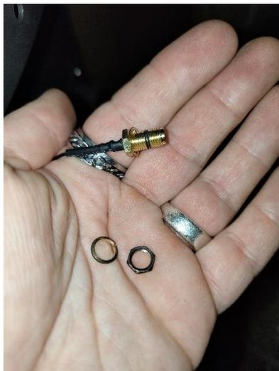
Setzen Sie den neuen Gewindeanschluss in das Loch ein, montieren Sie die Unterlegscheibe und schrauben Sie die Mutter auf:
