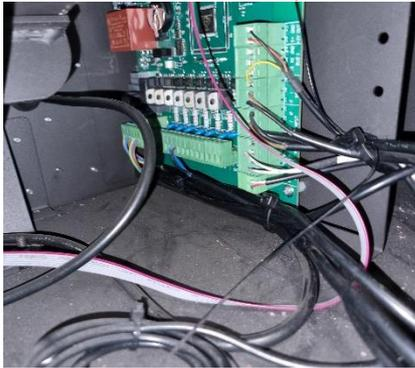
2. Wenn der Ofen an einer engen Stelle platziert ist, kann die Platine von vorne erreicht werden. Öffnen Sie die untere Ofentür und demontieren Sie die Platte an der unteren linken Ofenseite. Ziehen Sie die Platine vorsichtig heraus und stellen Sie dabei sicher, dass weder Platine noch Kabel beschädigt werden:
