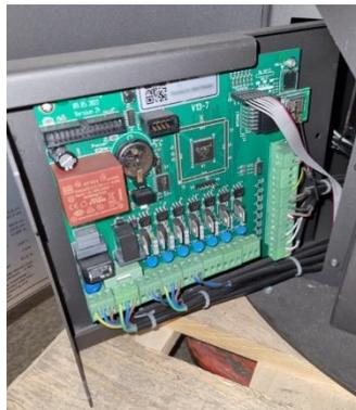
Entfernen Sie den alten WLAN-Kabelstecker und montieren Sie den neuen WLAN-Kabelstecker am WLAN-Print auf der Steuerplatine. Gehen Sie dabei vorsichtig vor, da der Stecker zerbrechlich ist:
