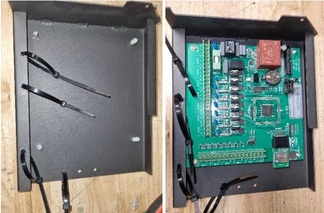
Verbinden Sie nun alle Kabelstecker mit der neuen Platine. Die Kabel müssen in die gleichen Steckplätze wie auf der alten Platine eingesteckt werden, wie unten gezeigt:
