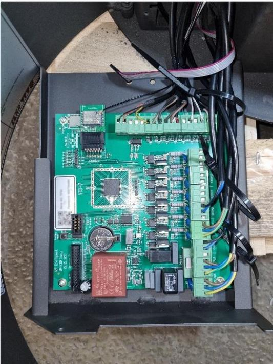
Bevor Sie die Kabelbinder festziehen, testen Sie, ob sich der Ofen wieder einschalten lässt. Setzen Sie die Platine sehr vorsichtig wieder in den Ofen ein und achten Sie darauf, dass Sie die Platine und die Kabel nicht beschädigen.
