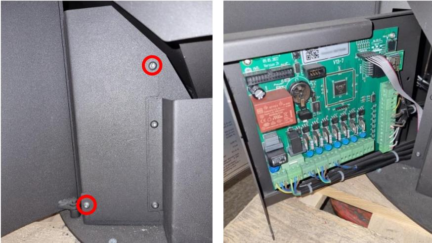
Legen Sie die Platine mit der Steuerplatine auf den Boden. Sie können die Kabel fotografieren oder beschriften, um sicherzustellen, dass sie beim Austausch der Platine wieder in den richtigen Steckplatz kommen.
