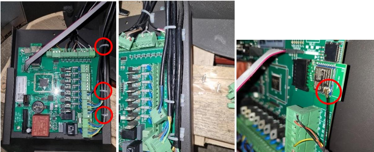
Lösen Sie die vier Schrauben (im Bild unten markiert), entfernen Sie die Platine von der Metallplatte und ersetzen Sie sie durch die neue Platine:
