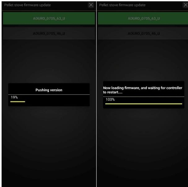
6. Si la mise à jour du firmware réussit, le poêle affichera la nouvelle version du firmware dans le coin inférieur droit :
