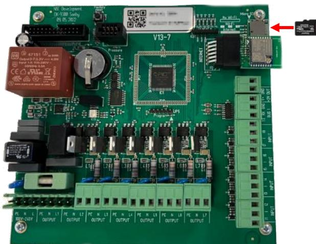
4. Connecter le poêle et l'allumer pendant 30 secondes. Dans la plupart des cas, l'écran clignotera avec les LED jaune et verte lorsque le micrologiciel a été installé.
