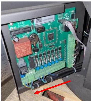
4. Tout en maintenant enfoncé le bouton de réinitialisation d'usine, connecter le poêle à l'alimentation électrique. Maintenir enfoncé le bouton de réinitialisation pendant au moins 15 secondes pendant que la carte s'allume.
