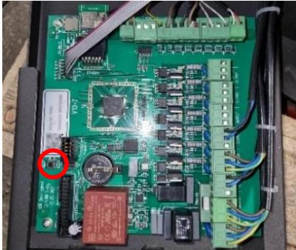
5. Mettre à nouveau le poêle hors tension et réinsérer la carte dans le poêle. S'assurer de réinstaller les vis qui maintiennent la plaque.
