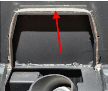
Retirer le guide pour le joint et remonter le brasier et les vermiculites.
