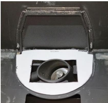
Retirer la bande adhésive sur le joint et placer le joint en forme de U autour du guide.
