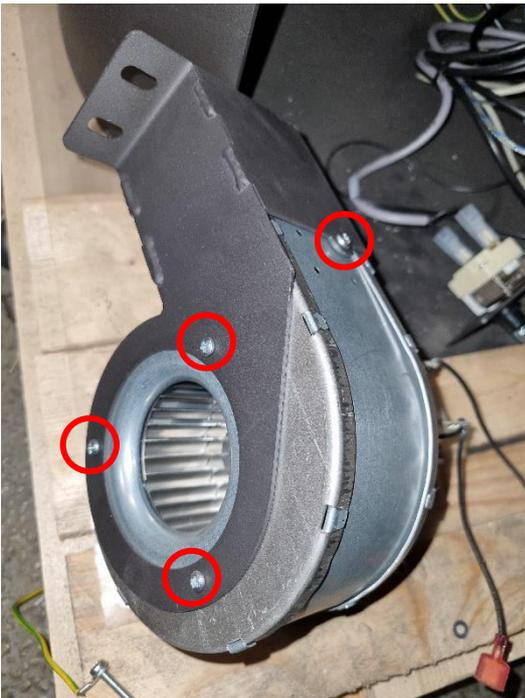
5. Avant de rattacher le support au nouveau ventilateur, s'assurer que les trous dans le conduit du ventilateur sont alignés avec le cache plaque du ventilateur. Le cache plaque peut être pivoté :
