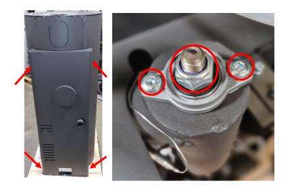
4. Maintenant, dévisser les quatre vis qui fixent le moteur au châssis du poêle :
