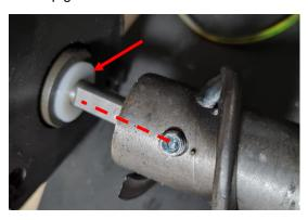
8. Pousser la vis sans fin, avec son motoréducteur, aussi loin que possible dans le tube à granulés. S'assurer que la tige filetée de la vis passe bien dans le trou à l'arrière du poêle:
