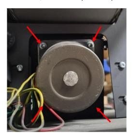
5. Retirer le motoréducteur et la vis sans fin, puis séparer la vis sans fin de son motoréducteur en dévissant la vis du pignon avec une clé Allen de 3 mm :
