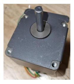
7. Remplacer le moteur, la vis sans fin ou les deux et réassemblez-les. S'assurer que la vis du pignon est alignée avec le côté plat de l'axe du moteur et qu'il y a une rondelle en nylon sur l'axe. Serrer la vis du pignon avec la clé Allen :
