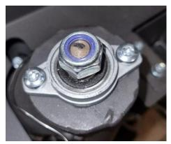
10. Pour monter le motoréducteur sur le poêle, celui-ci doit être placé correctement : L'axe n'étant pas centré sur le moteur, le petit côté est placé vers le bas :
