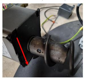
11. Faire pivoter le moteur (la pièce ronde) pour placer les câbles vers la gauche afin qu'ils puissent être facilement connectés au terminal. Revisser le moteur dans le châssis du poêle à l'aide des quatre vis. Ensuite, serrer la rainure sur la tige filetée à l'arrière du poêle.
