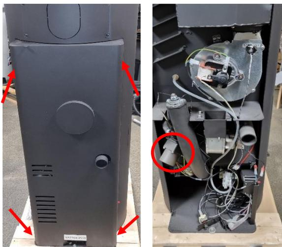
2. Débrancher les câbles du moteur du terminal blanc : Appuyer et maintenir enfoncés les boutons de verrouillage du terminal, puis retirer délicatement les câbles :
