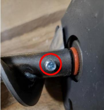
6. Transférer le support du couvercle de l'ancien moteur sur le nouveau moteur. Le support ne peut être installé que dans un seul sens et les trous doivent être visibles à travers les fentes pour vis, comme ceci :
