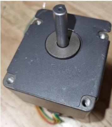
7. Avant de connecter la vis sans fin et le motoréducteur entre eux, s'assurer que le joint torique soit présent ainsi que la bague de verrouillage en étoile sur l'axe du moteur :
