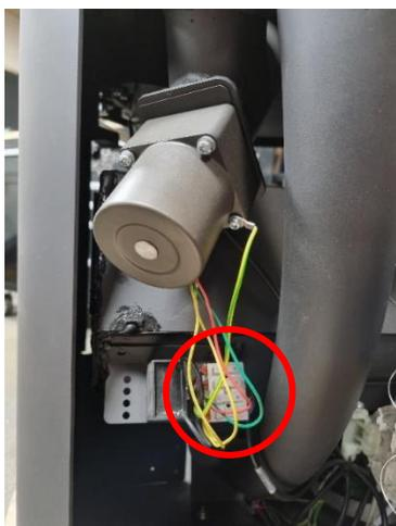
3. Dévisser les quatre vis qui maintiennent le motoréducteur. S'assurer de noter quelle vis appartient à quel trou et combien de rondelles se trouvent sur chaque vis, car elles doivent être repositionnées exactement au même endroit après le remplacement :
