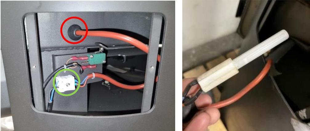
3. Installez la nouvelle bougie en céramique. Celle-ci doit être insérée dans le tube à l'intérieur du trou d'accès. Positionner le joint en caoutchouc et appuyez sur le câble jusqu'à ce que la bougie en céramique atteigne le haut du brasier. Tirez ensuite le câble orange de 5 mm vers l'arrière.
