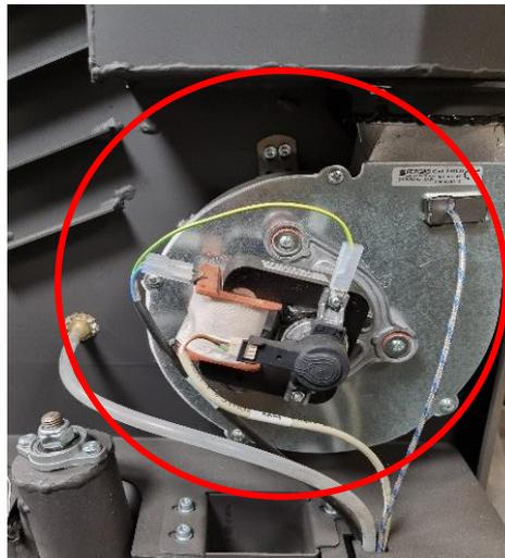
2. Démontez le capteur du ventilateur extracteur en ouvrant le couvercle métallique, puis retirez le câble. Retirez le feutre, dévissez la vis cruciforme puis retirez le capteur et la plaque :
