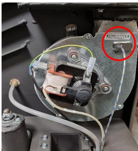
2. Démontez le capteur en ouvrant le capot métallique, puis retirez le câble :
