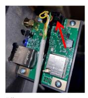
7. Effectuer une connexion sur l'application Aduro Pellet Stove pour tester si le module Wi-Fi fonctionne (Guide Connexion application Wi-Fi). S'il ne fonctionne pas, suivre les étapes de dépannage ci-dessous.
