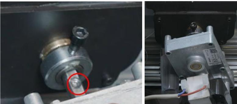
6. Effectuer une "Charge Initiale" avant tout allumage du poêle. Si les granulés tombent au sein du brasier, alors le moteur de vis sans fin est correctement positionné.
