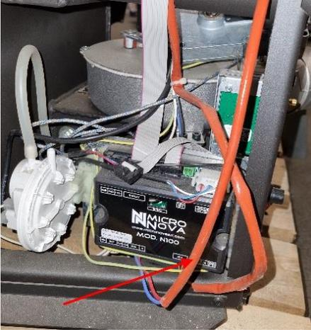
Le câble du moteur de vis sans fin doit être connecté à la sortie "coc." sur la carte mère Micro-Nova N100 au sein du poêle. Il est connecté grâce à un connecteur groupé :
