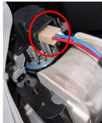
7. Avant de remonter le capteur de température, assurez-vous d'appliquer une nouvelle couche de silicone résistant aux hautes températures pour fixer et sceller le capteur :
