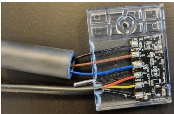
6. Monter le nouveau boîtier de contrôle, et connecter les fils au Draft Optimizer et à la boîte de contrôle :
