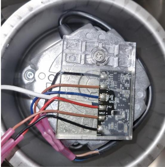
7. Remonter le cache et la plaque supérieure et tester le Draft Optimizer pour s'assurer que cela fonctionne.
