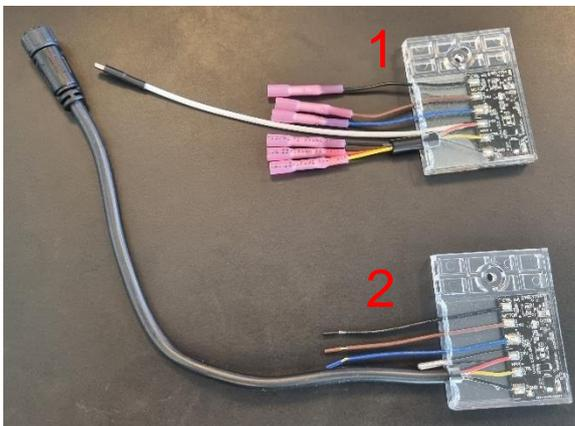
La différence entre les deux est le connecteur à l'arrière. Sur la première carte, le câble a été séparé et chaque fil doit être connecté au Draft Optimizer. Sur le deuxième panneau, le connecteur doit juste être remplacé par celui présent sur le Draft Optimizer et les trois fils restants doivent être connectés à ceux présents sur le boîtier de contrôle.
